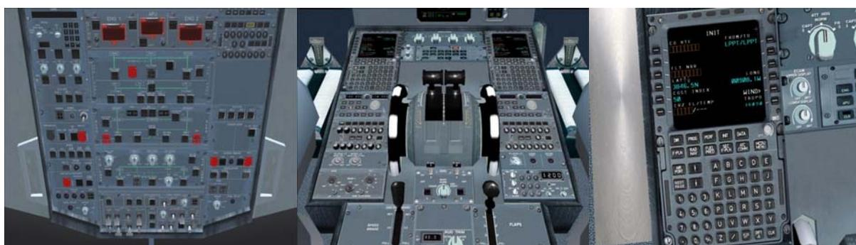
Figura 48 – Painéis de Airbus A320 simulados em PC: “overhead”, “pedestal” e “MCDU”.
