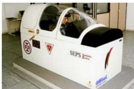
**Figura 35 – *SEPS*<sup>TM</sup>: simulador “full-size” do “*Epsilon*” (sediado em Beja). Sistema fisicamente robusto.**
