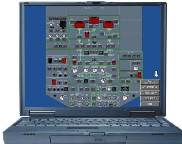
Figura 26 – PC com *software* de simulação de sistemas. Na imagem, o *overhead panel* do Airbus A320.
