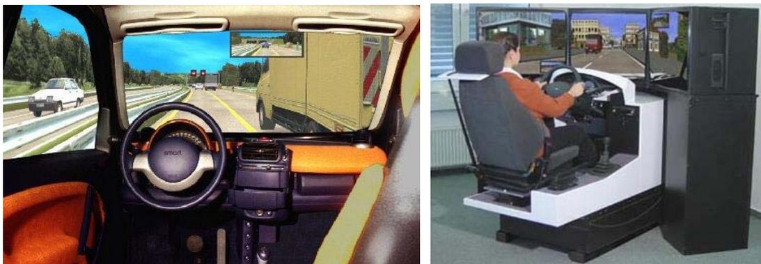
Figura 14 – Simulador de cabine completa (*Smart*) e simulador com consola (*Ford Focus*).
