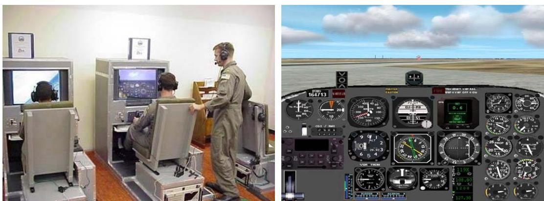
Figura 30 – *US-Navy*: utilização de plataformas *PC* de simulação (*software MSFS™*), *COTS*, nos cursos de formação em pilotagem de aeronaves; à direita, o painel da aeronave de treino *T-34C*.
