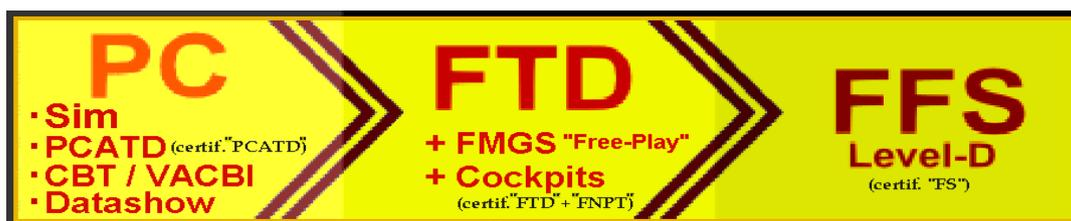
Figura 19 – Espectro de complexidade dos dispositivos-de-treino-sintético: PC–FTD–FFS.
