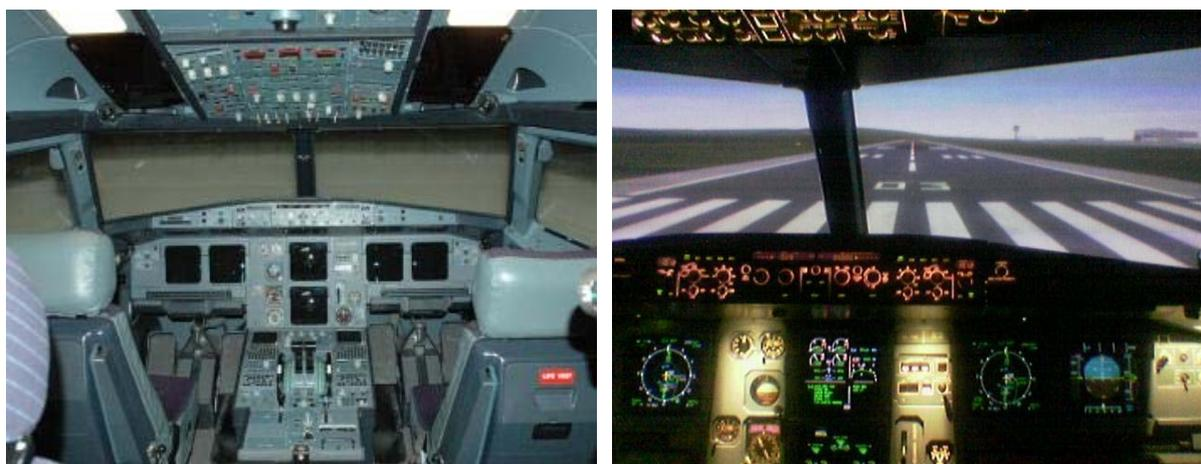
Figura 16 – *Simulador de Voo* para qualificação de Tipo *A319-A320-A321* (“*JAR-STD-1A–Level-D*”), utilizado pelo *Training Center* da companhia de aviação *TAP*; à direita, a pista *03* do aeroporto de Lisboa.
