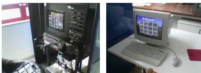
Figura 32 – *PCATD* do Laboratório de Aviónica e Controlo (UBI). Inclui posto de instrutor (à direita).
