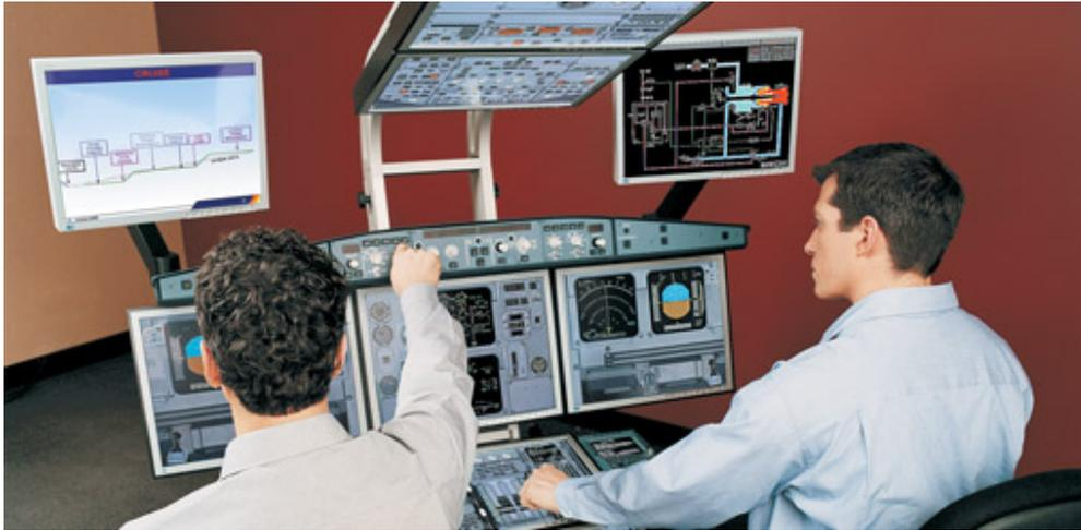
Figura 27 – *Integrated Procedures Trainer™* – simulação digital de sistemas de *cockpit* de um *Airbus A320*.
