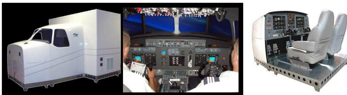
Figura 17 – 2 exemplos de simuladores com cabine física: total ou parcial / de ecrã exterior ou embutido.
