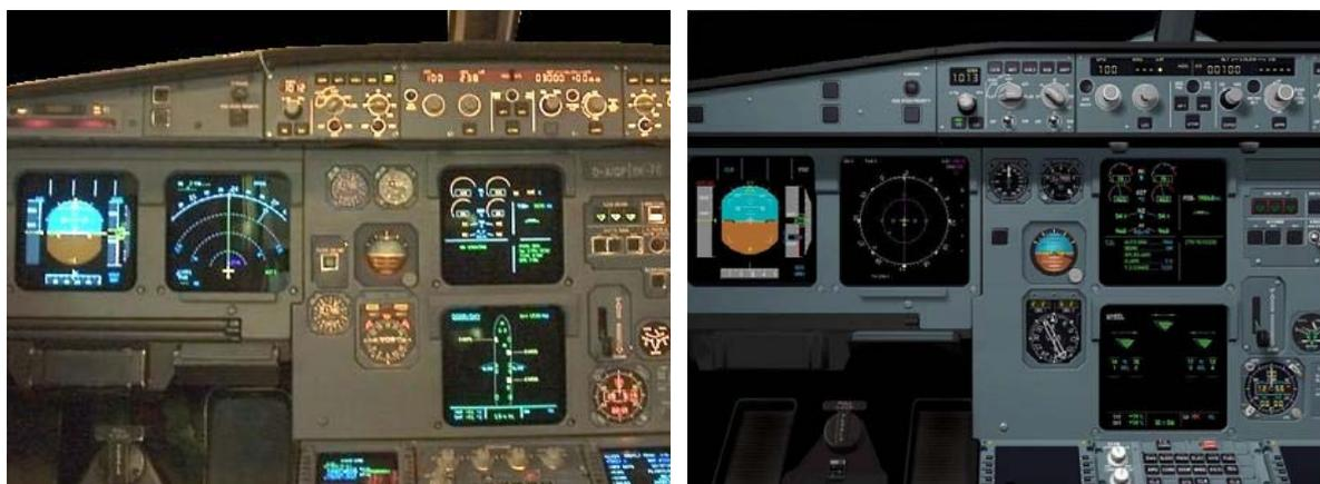
Figura 47 – Airbus A320 – cockpit utilizado nas operações: FS (real), à esquerda; PC (virtual), à direita.
