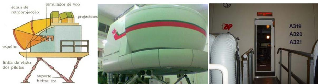
**Figura 15 – Simulador de Voo (FS) de qualificação de Tipo de avião Airbus A320, Training Center/TAP.**
