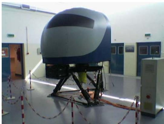
**Figura 39 – GYROGMA™: simulador de desorientação espacial baseado em arquitectura *PC*.**
