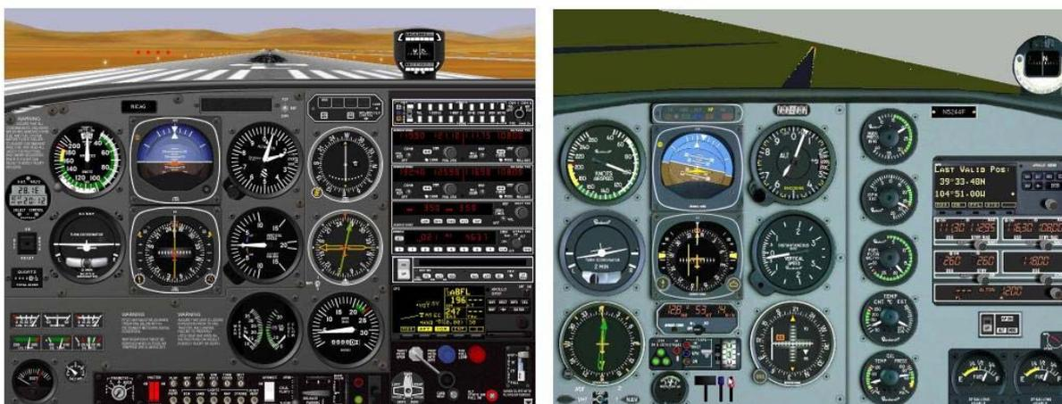
**Figura 21 – Painéis / visuais de simuladores de voo para PC para treino em qualificação em Voo por Instrumentos (Elite Simulation Solutions v8, à esquerda, e Jeppesen FlitePro, à direita).**
